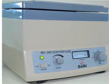
CENTRÍFUGA CLÍNICA COM ROTOR DE ÂNGULO FIXO, COM CAPACIDADE PARA 12 TUBOS DE 15 ML, OU 12 TUBOS DE 10 ML TIMER E VELOCIDADE REGULÁVEL ATÉ 4000RPM, COM TRAVA DE SEGURANÇA QUE INTERROMPE O FUNCIONAMENTO COM A TAMPABERTA
