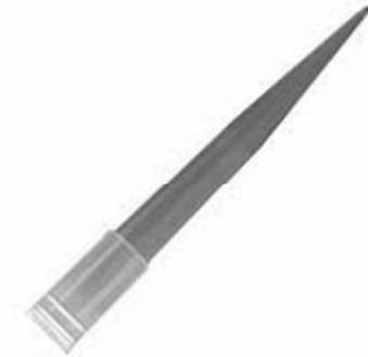
Ponteira universal em polipropileno transparente atóxico com 99.9% de pureza, marca Axygen, modelo Universal Fit Tips, capacidade de 100-1000ul, cor azul, sem filtro, livre de DNase, RNase e não pirogênicos. São designadas para encaixar em uma grande variedade de micropipetas mono e multicanal. Autoclavavel até 121° C por 15 minutos a 15psi.
