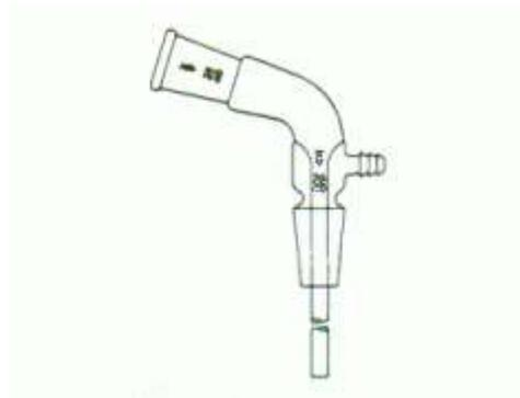
Tubo conectante, ângulo 105°, e saída para tomada de vácuo com juntas esmerilhadas intercambiáveis, junta fêmea 24/40, junta macho 24/40
