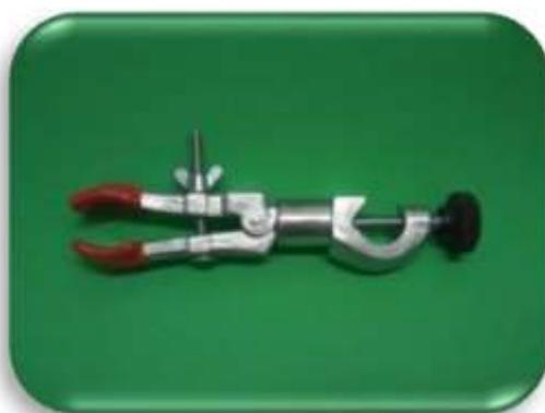
Pinça para bureta, fabricada em alumínio, regulagem de abertura por molas de pressão, com mufa, parafuso de fixação tipo borboleta, em alumínio e poliestireno colorido injetado. comprimento cerca de 250 mm, acabamento jateado.
